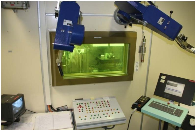
Abb. 4.10: Heiße Zelle mit integrierter Drahterodiermaschine AGIECUT CLASSIC.
